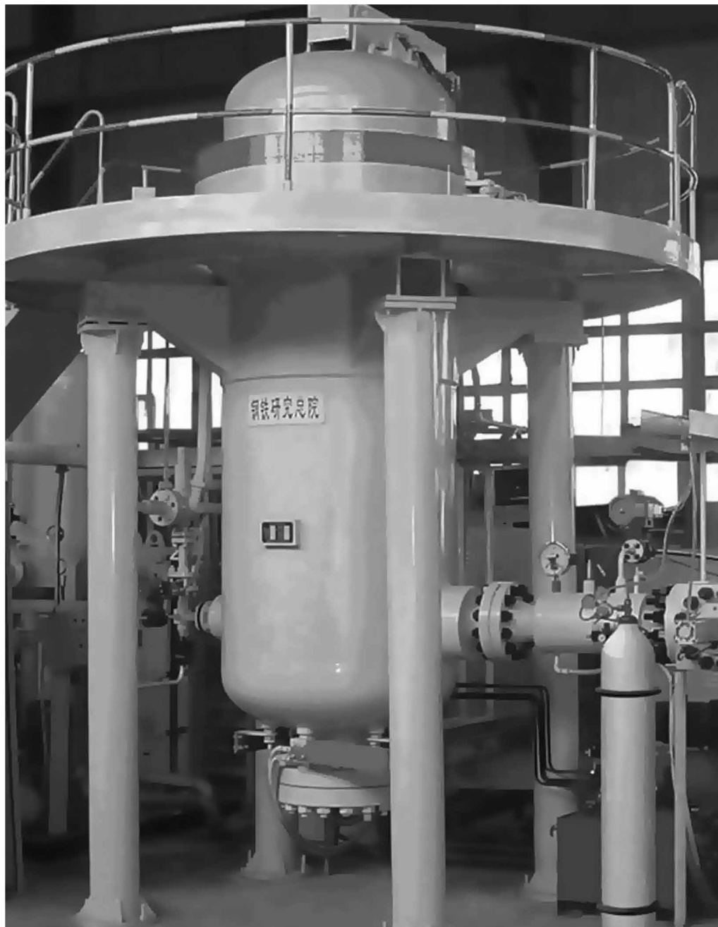
Presse isostatique chinoise, du même type que celles construites par l'entreprise belge Epsi
